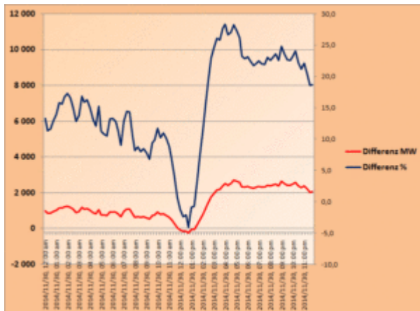
Bild 2. Tagesverlauf der absoluten Abweichung in fehlenden MW eingespeister WEA-Leistung (rot, linke Vertikalachse) sowie die prozentuale Abweichung (rechte Vertikalachse) am 30. November 2014 (Daten: EEX)
