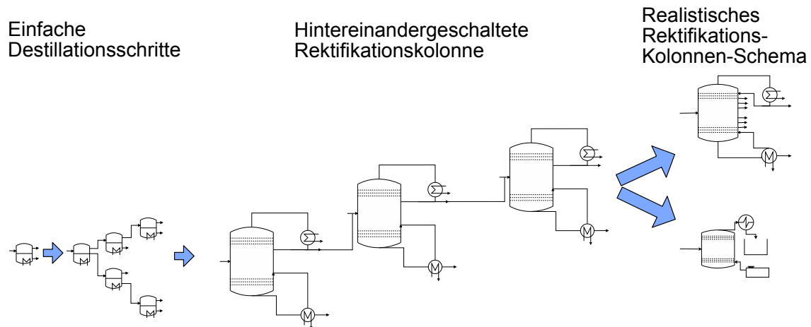
Abbildung 5.4: Simulationsmodelle zur Rektifikation: Von der einstufigen Destillationsstufe zur Rektifikationskolonne
